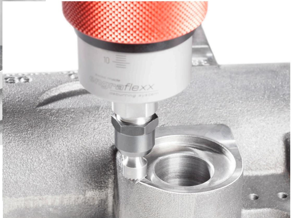
automatisiertes Entgraten von undefinierten Kanten
