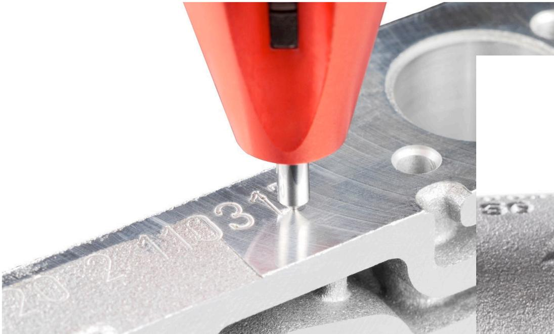
Prozess-integrierte Teilebeschriftung auf CNC-Maschine
