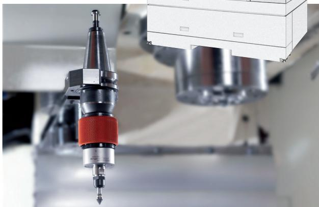
Versione con mandrino di azionamento integrato in uso per la sbavatura pezzi con robot
