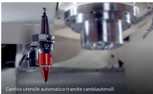
Cambio utensile automatico tramite cambiautensili
