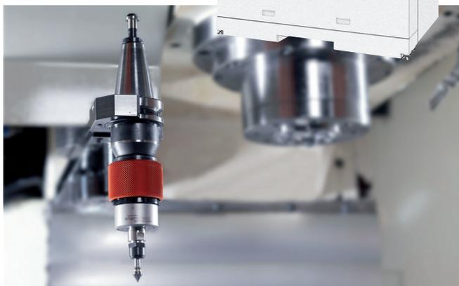
Version avec broche d'entraînement intégrée utilisée pour l'ébavurage de pièces avec un robot
