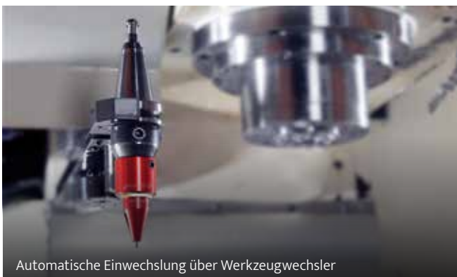
Vertikale Schwingfrequenz der Beschriftungsnadel 300 Hz
