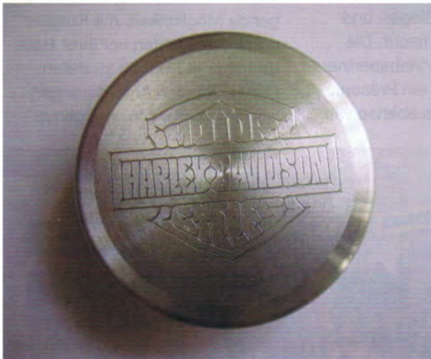
Bild 2: Mit Rollprägewerkzeug beschriftetes Logo. Aufgrund der abrollenden Kugel an der Beschriftungsnadel entstanden an der Werkstückoberfläche kaum messbare Vertiefung bzw. Aufwurf
