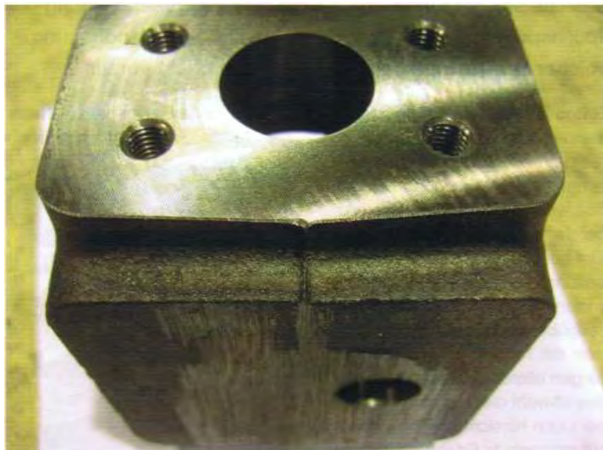
Bild 3: An diesem mit engraflexx EC entgrateten Gehäuse ist sehr gut ersichtlich, wie das Werkzeug immer exakt der zu entgratenden Kontur folgt. Die Spindel wurde beim Entgraten sogar durch die spitz vorstehende Gusstrennfuge ausgelenkt (Werkbilder: SEH Technik GmbH, CH-Oberuzwil)
