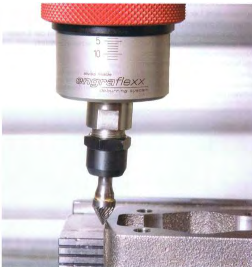
Bild 1: In dieser Detailaufnahme ist die seitlich ausgelenkte Spindel des Werkzeugsystems sehr gut ersichtlich
