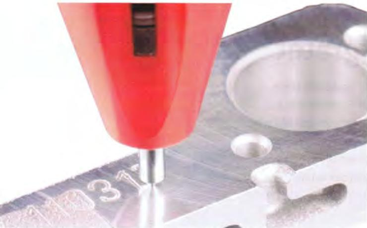
**Beschriftungswerkzeug für die automatische In-Prozess-Beschriftung.**
