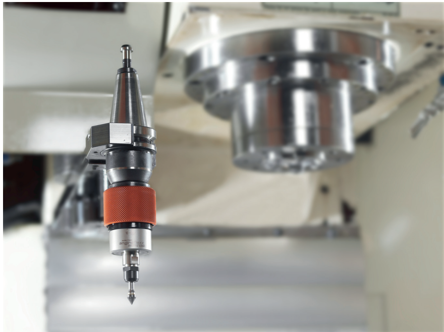
Bild 2: Das Werkzeugsystem engraflexx EC wird wie ein konventionelles Werkzeug über den Werkzeugwechsler eingewechselt
